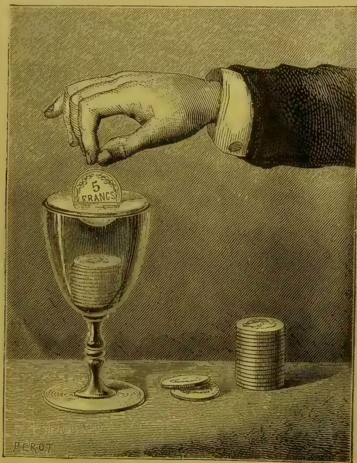
Fig. 64. Esperimento sulla convessità dei menischi.
